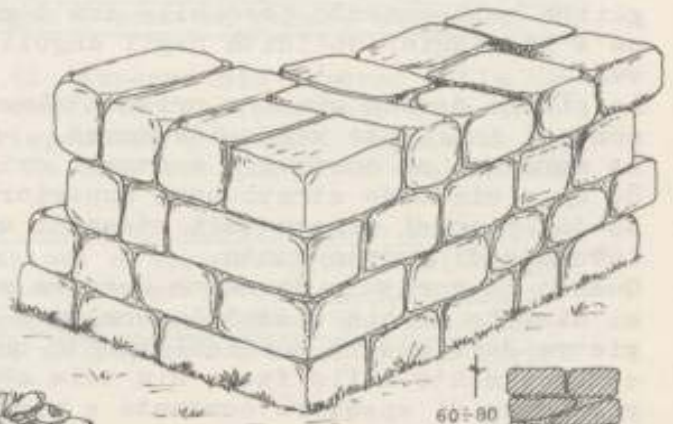
Fig.4/M - Muratura costruita seguendo la buona norma.
